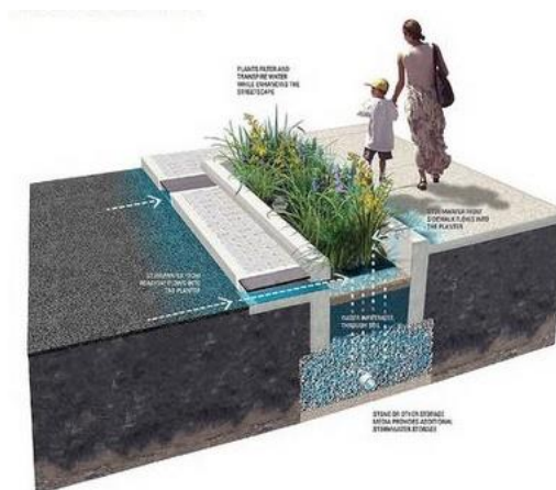
Attēls. Ielu apstādījumi kalpo kā lietussūdens savākšanas un attīrīšanas iepakojums
