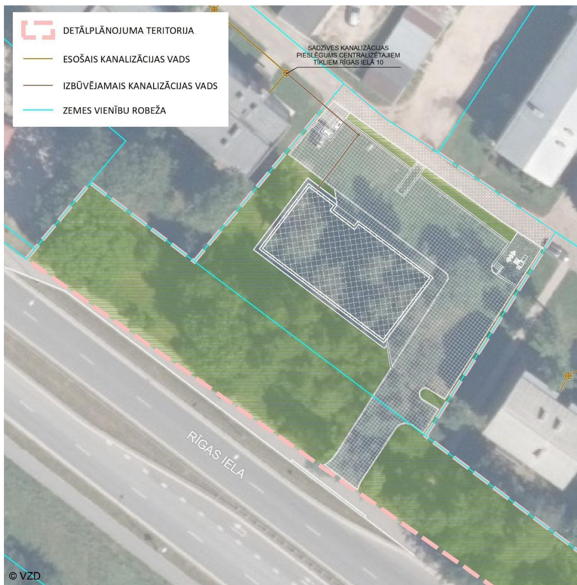
17. att. Sadzīves kanalizācijas novadīšanas risinājumi
