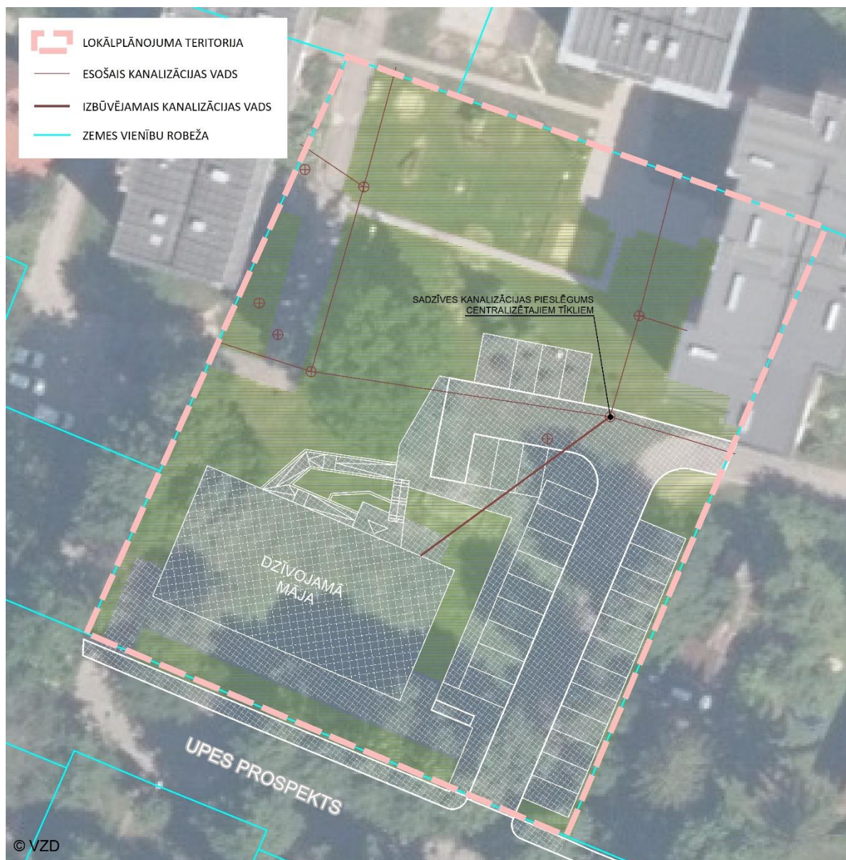
18. att. Sadzīves kanalizācijas novadīšanas risinājumi (shematiski risinājumi)
