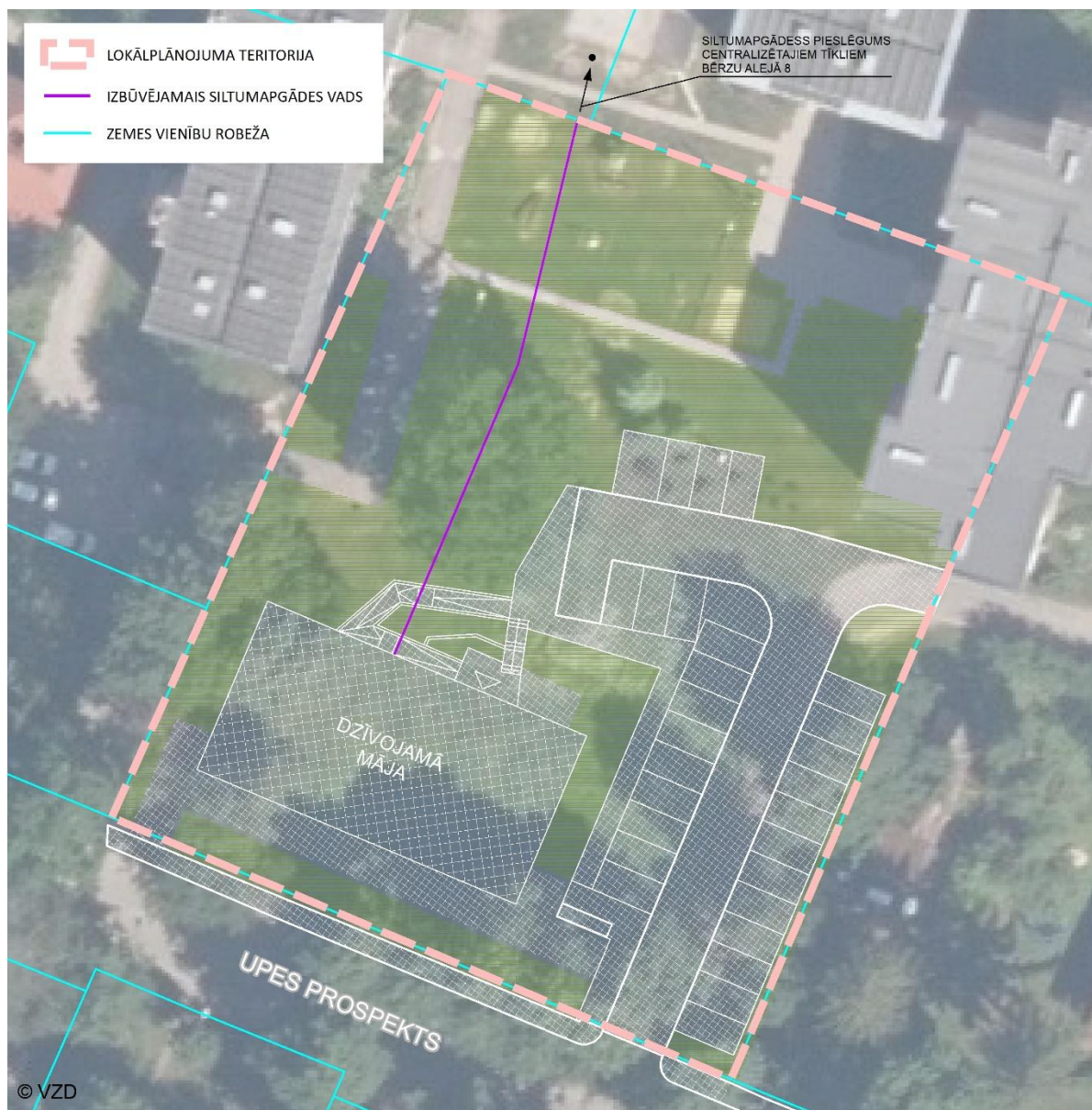
19. att. Siltumapgāde (shematiski risinājumi)
