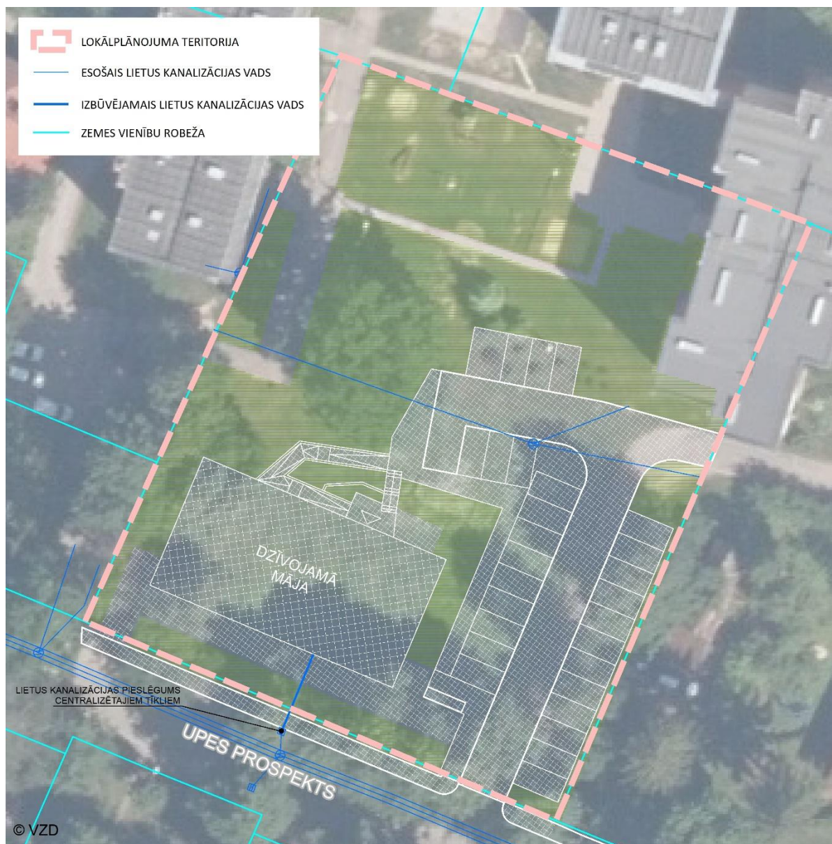
20. att. Lietus kanalizācijas novadišanas risinājumi (shematiski risinājumi)
