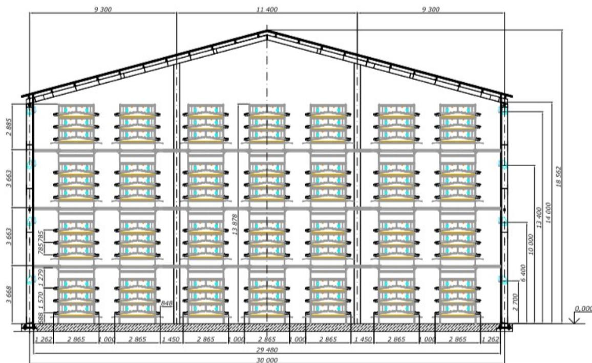
**3.6. attēls. Dējējvistu turēšanas novietnes šķērsgrīzuma profils**
